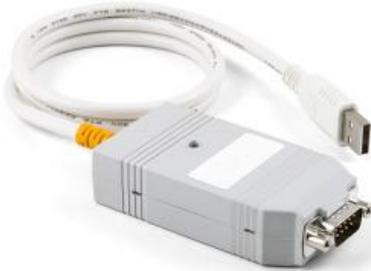
Le PLIN-USB permet la connexion d'un ordinateur Windows à un réseau LIN via USB. L'adaptateur supporte le protocole LIN respectant le Standard ISO 17987 et est conforme à toutes les spécifications LIN jusqu'à la version 2.2. L'interface peut fonctionner en mode Maître ou en mode Esclave.
