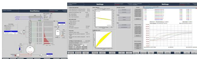
Simuler interactivement le comportement d'une colonne de rectification avec le logiciel Virtual Distillation.
