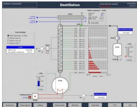
Simuler interactivement le comportement d'une colonne de rectification avec le logiciel Virtual Distillation.
