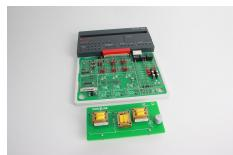
Cours sur les montages redresseurs non commandés et commandés constitué d'une carte d'expérimentation avec différents circuits ; à utiliser avec l'unité centrale.
