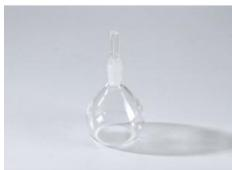
Pour mesurer la densité de liquides, on dispose du pycnomètre de Gay-Lussac dans l'expérience P1.1.2.3. Il sagit de déterminer la densité de mélanges d'eau et déthanol.
