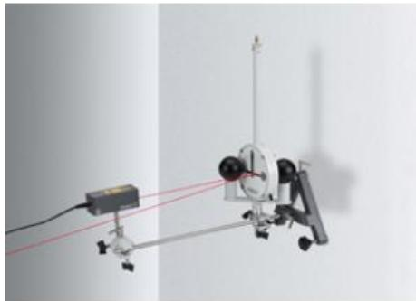
Durant l'expérience P1.1.3.1, c'est un rayon laser qui fait office de spot lumineux. Il est réfléchi sur une échelle graduée par le miroir concave du pendule à torsion. Sa position sur l'échelle est tracée manuellement point par point en fonction du temps.
