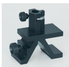
Cavalier pour banc d'optique à profil normalisé.
