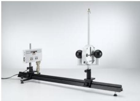
Le mouvement des sphères de plomb dans la balance de gravitation peut être suivi automatiquement avec le détecteur de position à infrarouge (IRPD: IR Position Detector).
