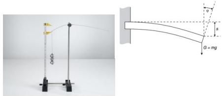
Dans l' expérience P1.2.1.2, on étudie la flexion d'un ressort à lame serré d'un seul côté et soumis à l'action d'une force connue, obtenue en suspendant des masses marquées.
