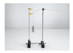
Dans l'expérience P1.2.1.2, on étudie la flexion d'un ressort à lame serré d'un seul côté et soumis à l'action d'une force connue, obtenue en suspendant des masses marquées. La déformation est dans ce cas aussi proportionnelle à la force agissante.
