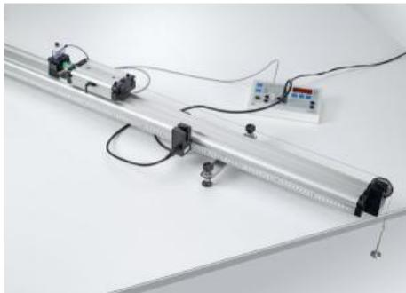
**P1.3.2.1 Relevé des diagrammes distance-temps de mouvements rectilignes**
