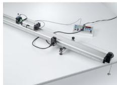
Durant l'expérience P1.3.2.1, une approche expérimentale de la définition de la vitesse  $v$  en tant que quotient de la différence de distance  $s$  par la différence de temps  $t$  correspondante est possible avec des moyens simples. La différence de distance  $s$  est relevée directement sur le rail à l'aide d'une règle graduée.
