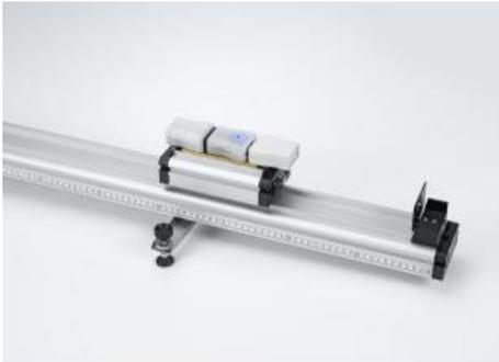
Dans l'expérience P1.3.2.5, il s'agit de mesurer sans contact l'accélération  $a(t)$  que subit un chariot pour rail uniformément accéléré. La méthode de mesure consiste en l'utilisation d'un capteur d'accélération 3 D associé à un Pocket-CASSY 2 Bluetooth. Grâce à sa haute résolution, le capteur permet la mesure immédiate d'accélérations assez faibles sur un rail.
