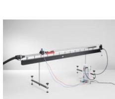
Les mouvements uniformes et uniformément accélérés sur le banc à coussin d'air en position horizontale font l'objet de l'expérience P1.3.3.4.
