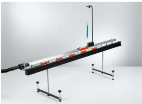
Pour étudier la relation entre réaction et conservation de l'impulsion, la force de réaction sur un mobile à réaction est calculée au cours de l'expérience P1.3.4.10 pour différentes sections d'air à l'aide d'un capteur de forces.
