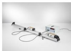
Durant l'expérience P1.3.4.6, on mesure le temps  $t_1$  durant lequel les faisceaux de deux barrières lumineuses sont interrompus par deux mobiles placés sur le rail à chariot, avant ou après un choc élastique ou inélastique.
