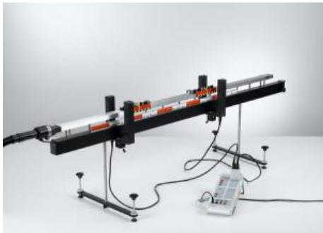
Durant l'expérience P1.3.4.8, on mesure le temps  $t_1$  durant lequel les faisceaux de deux barrières lumineuses sont interrompus.
