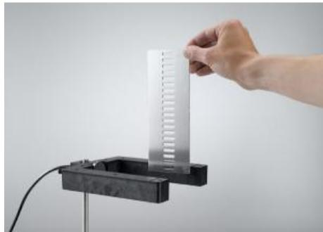
**P1.3.5.3 Chute libre : Mesure multiple du temps avec une échelle g**
