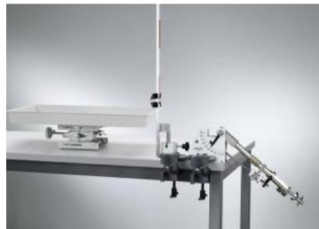
**P1.3.6.1 Tracé point par point de la trajectoire en fonction de la vitesse et de l'angle de tir**
