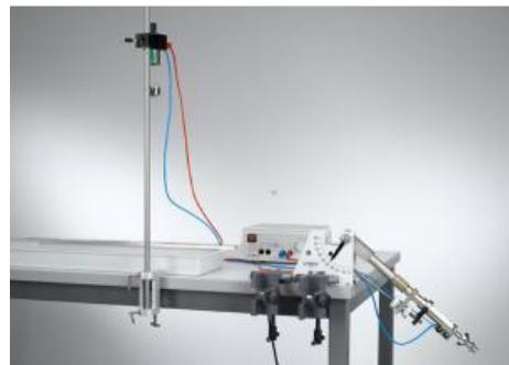
**P1.3.6.2 Principe de superposition: comparaison entre le jet oblique et la chute libre**
