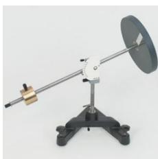
Pour l'observation des phénomènes gyroscopiques ainsi que pour la démonstration et la mesure de mouvements de précession et nutation, avec trois axes à double roulement à billes très maniables - pour axe vertical - pour axe horizontal - dans disque gyroscopique.
