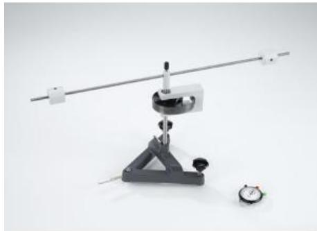
L'expérience P1.4.5.1 consiste à déterminer le moment d'inertie d'une masse ponctuelle en fonction de l'écart  $r$  à l'axe de rotation.
