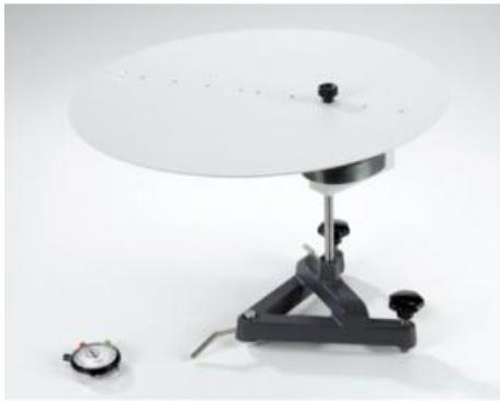
Dans l'expérience P1.4.5.3, on vérifie expérimentalement le théorème de Steiner sur l'exemple d'un disque plat.
