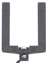
Barrière lumineuse de précision avec source à infrarouges pour la commande d'appareils de comptage et de mesure du temps pour l'expérimentation avec des corps en mouvement, par ex. pour l'étude du mouvement sur le rail, de la chute libre, des oscillations d'un pendule, de ressorts à lame ou de cordes.
