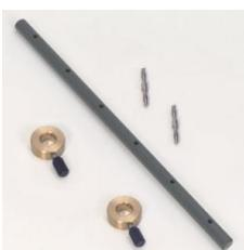
Tige ronde avec deux masses déplaçables pour l'étude des oscillations d'un pendule composé ou d'un pendule réversible à l'aide d'un capteur de rotation S ( 524 082 ).
