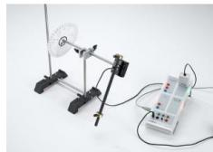
Dans l'expérience P1.5.1.6 on monte et étudie un pendule à accélération de la pesanteur variable (pendule g variable).
