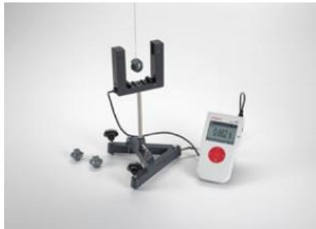
Dans l'expérience P1.5.1.7, on utilise un poids sur une fil pour déterminer l'accélération de la pesanteur. Comme la masse du poids est considérablement plus élevée que celle du fil auquel il pend, le pendule peut être considéré comme une bonne approximation d'un pendule mathématique.
