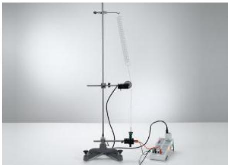
**P1.5.2.1 Oscillations d'un pendule à ressort et détermination de la période d'oscillation d'un pendule à ressort en fonction de la masse oscillante - Mesure avec CASSY**
