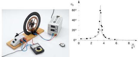
Au cours de l'expérience P1.5.3.2, le pendule de torsion est amené à des oscillations de fréquence  $\omega$  par un moment de torsion variant harmoniquement.
