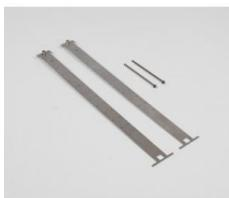
Pour des essais d'oscillations, avec 2 axes pour la fixation sur le bloc de noix ( 301 25 ) ou pour la fixation sur des noix.
