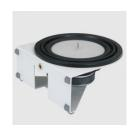
Permet d'étudier les sons basse fréquence et de faire vibrer des cordes (dispositif expérimental de Melde) ainsi que des ressorts à boudin. Avec plaque pour la génération de fronts d'ondes planes ainsi que goujon fileté permettant par ex. de fixer un crochet. Support avec douilles filetées pour la tige support (inclus au matériel livré).
