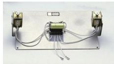
Permet d'arrêter simultanément la totalité des pendules du module de base ( 40120 /21) pour ainsi visualiser l'état instantané (figé) d'une onde.
