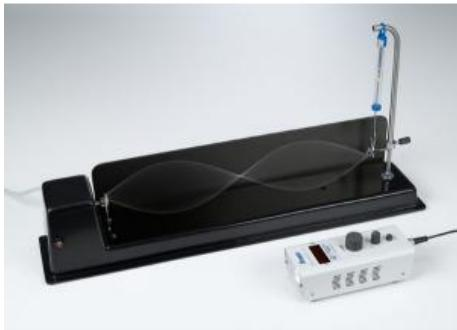
Dans l'expérience P1.6.3.2, on utilise en plus un stroboscope pour le même programme de mesure. Il sert d'une part à déterminer la fréquence d'excitation  $f$  du moteur, d'autre part, à bien visualiser la polarisation circulaire de l'onde lorsque l'onde stationnaire le long de la corde est éclairée par les éclairs du stroboscope, dont la fréquence est proche de la fréquence d'excitation.
