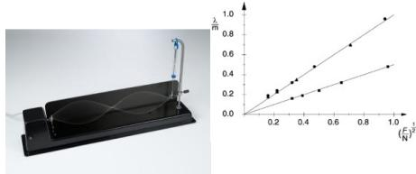
Au cours de l' expérience P1.6.3.1, on détermine, pour une fréquence d'excitation fixée, les longueurs d'onde  $\lambda$  des ondes stationnaires pour différentes longueurs de corde  $s$  et différentes masses de corde  $m$ .
