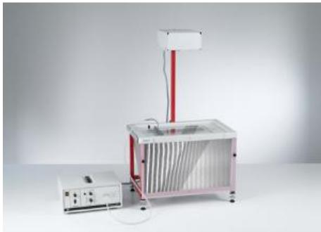
La propagation des ondes dans des profondeurs d'eau différentes fait l'objet des expériences P1.6.4.3 et P1.6.4.4. Une profondeur d'eau plus importante correspond à un milieu optiquement plus faible ayant un indice de réfraction  $n$  moins élevé.
