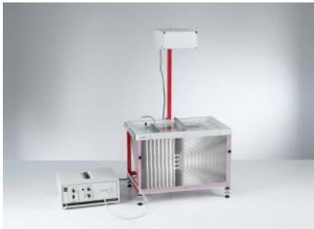
L'objet de l'expérience P1.6.5.4 est la diffraction par des fentes doubles, triples ou multiples d'ondes rectilignes à la surface de l'eau.
