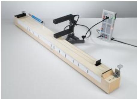
Au cours de l'expérience P1.7.2.1, on détermine la fréquence de vibration de la corde en fonction de sa longueur et de sa tension.
