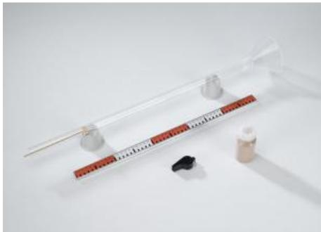
**P1.7.3.1 Tube de Kundt: Détermination de la longueur d'onde avec la méthode de la poussière de liège**
