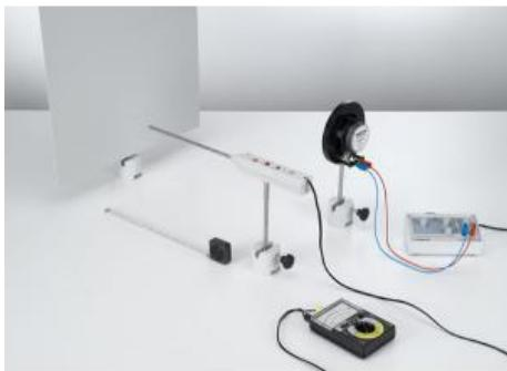
Au cours de l'expérience P1.7.3.2, des ondes stationnaires apparaissent par réflexion sur une paroi. Pour cela, des ondes sonores sont produites dans l'ensemble du domaine audible par un générateur de fonctions et un haut-parleur. On cherche les minima d'intensité avec un microphone puis on déduit la longueur d'onde d'après les écarts entre ces minima.
