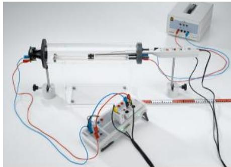
**P1.7.3.3 Détermination de la vitesse du son dans l'air en fonction de la température**
