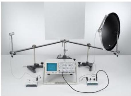
Le but de l'expérience est de vérifier la loi de la réflexion «angle d'incidence = angle de réflexion» pour les ondes ultrasonores.
