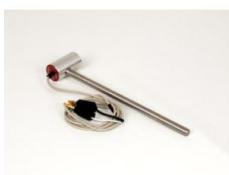
Transmetteur d'ultrasons piézoélectrique pour des expériences sur l'acoustique mécanique, géométrique, ondulatoire et pour l'étude de capteurs à ultrasons.
