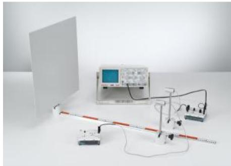
On utilise au cours de l'expérience P1.7.4.2 le principe de l'écho-sonde pour déterminer la vitesse du son dans l'air et également pour déterminer des distances.
