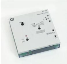
Générateur de signaux rectangulaires servant de module d'alimentation pour le transducteur d'ultrasons 40 kHz ( 416002 ).
