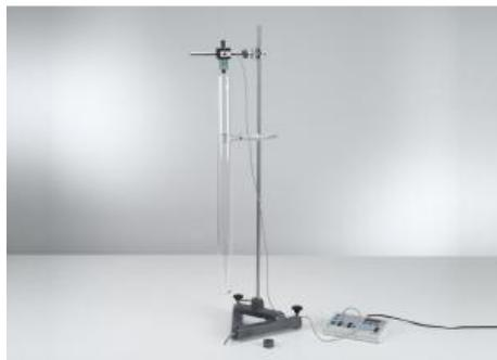
L'objet de l'expérience P1.8.3.1 est la construction d'un viscosimètre à chute de bille puis l'étude de la méthode de mesure sur l'exemple de la viscosité de la glycérine.
