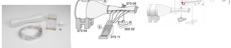
Pour l'étude de la pression statique à l'intérieur d'un tube à étranglement.
