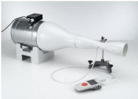
**P1.8.5.4 Pression statique et détermination de l'écoulement volumétrique avec un tube de Venturi**
