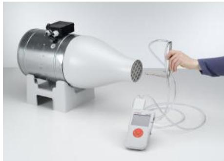
**P1.8.5.6 Détermination de la vitesse du vent avec une sonde de pression dynamique**
