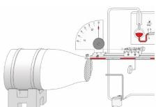
Dynamomètre de précision pour la mesure de la résistance à l'écoulement de l'air dans la veine d'essais pour l'aérodynamique ( 37306 ) ou dans le tunnel aérodynamique ( 37312 ).
