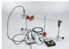
L'expérience P3.7.5.1 consiste cependant à étudier le guidage de micro-ondes le long d'une ligne de Lecher. Pour ce faire, on mesure la tension le long de la ligne à l'aide d'une sonde de champ électrique. On détermine la longueur d'onde à partir de l'écart entre les maxima.
