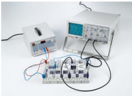
P4.1.6.3 Transistor en tant que générateur d'ondes sinusoïdales (oscillateur)
