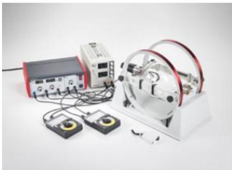
Au cours de l'expérience P6.1.3.1, pour déterminer la charge spécifique de l'électron, un fin jet électronique concentré est dévié dans un champ magnétique homogène, suivant ainsi une trajectoire circulaire fermée. On détermine en fonction de la tension accélératrice  $U$  le champ magnétique  $B$  force les électrons à suivre cette trajectoire de rayonné.
