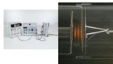
Lexpérience de Franck et Hertz avec le néon est proposée en deux variantes, expériences P6.2.4.3 et P6.2.4.4, qui se différencient lune de lautre uniquement par le tracé et lexploitation des données mesurées. Dans les deux variantes, les atomes de néon sont dans un tube en verre avec quatre électrodes: la cathode K, lélectrode de commande G1 en forme de grille, la grille daccélération G2 et lélectrode collectrice A.
