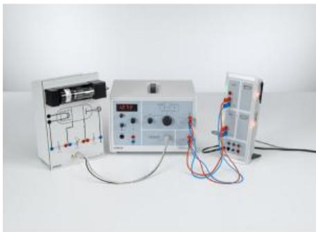
L'expérience de Franck et Hertz avec le néon est proposée en deux variantes, expériences P6.2.4.3 et P6.2.4.4, qui se différencient l'une de l'autre uniquement par le tracé et l'exploitation des données mesurées.
