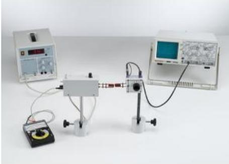
L'objet de l'expérience P6.2.6.3 est la mise en évidence de l'absorption résonnante avec un circuit oscillant passif.
